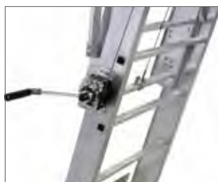
Regulacja wysokości za pomocą ręcznej wyciągarki
