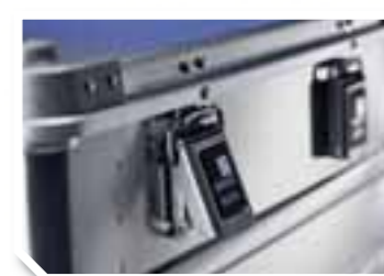
Zamknięcie/hak zapadkowy z aluminium/stali nierdzewnej. Odporne na korozję, możliwość użycia plomb, zamka wkładanego i dźwigniowego do grubości kabłąka 6 mm oraz sprężyny zabezpieczającej przed odskoczeniem.
